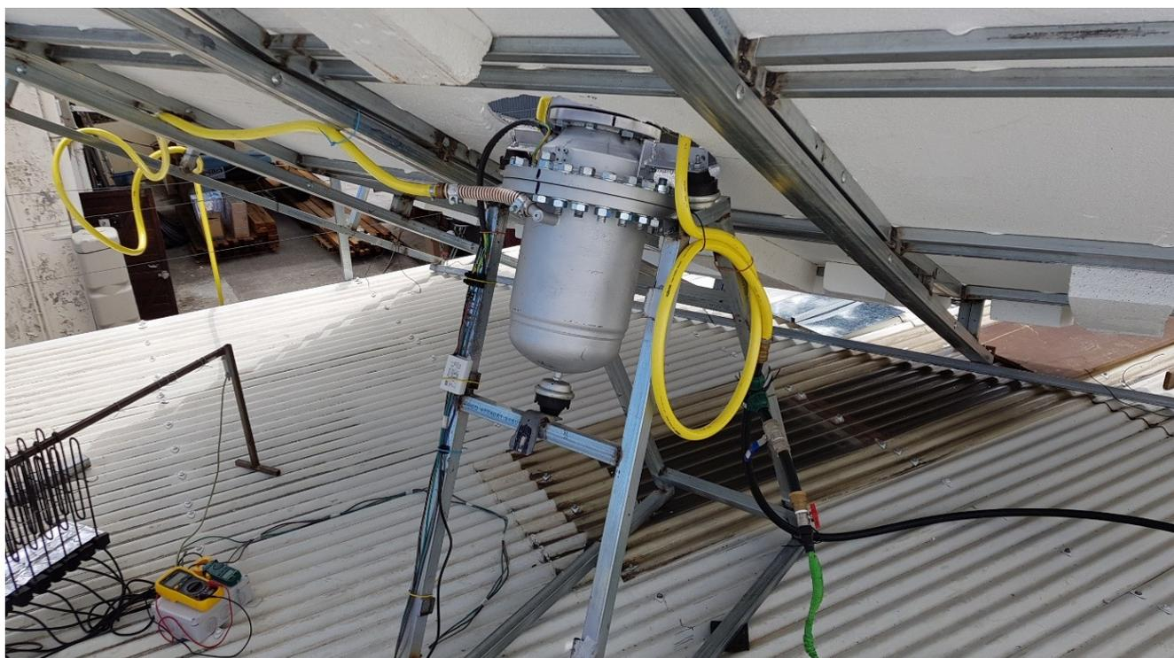
**Photo 3** : le soleil apprivoisé, impressionnante démonstration des 23kw solaires concentrés en un point.
